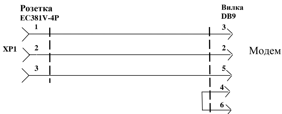
Рисунок 5.4 Схема кабеля для подключения внешнего сотового модема Siemens MC-35
